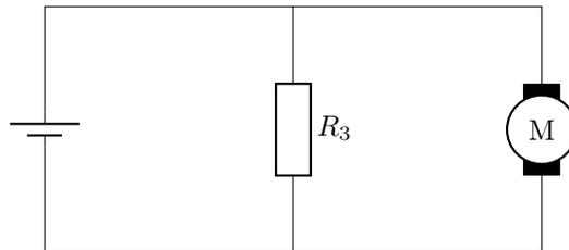
On modélise la pile par un générateur de Thévenin de f.é.m  $E_1 > 0$  et de résistance interne  $R_1$ . Le moteur électrique transforme une partie de la puissance électrique reçue en puissance mécanique, le reste étant dissipée par effet Joule. On modélise le moteur à l'aide d'une source idéale de tension de f.é.m  $E_2 > 0$  en série avec une résistance  $R_2$ , comme ci-dessous.
