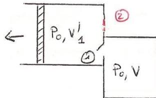
le système à considérer est l'air contenu dans le réservoir et dans le corps de la pompe.
