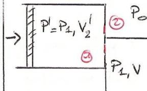
le gaz contenu dans la pompe est comprimé à  $T$  constante :  $V' \downarrow$  et  $P' \uparrow$ .
