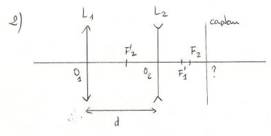
$O_1O_2 = d = 15 \text{ scm}$ .  $O_1F_1 = f_1 = 20 \text{ cm}$ .  $O_2F_2 = -f_2' = 5 \text{ cm}$  F2 légèrement en avièr de  $F_1'$ . La position du capteur n° est pas comme à ce stade. On a la serie de conjugaisons suivante
