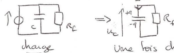
Une fois chargé, certains électrons peuvent traverser l'isolant et conduire à un rééquilibrage des charges sur les armatures, et provoquer une baisse de la tension.
