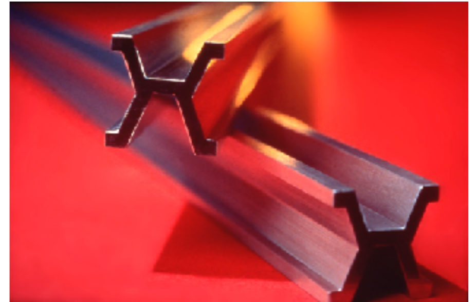
Prototype en platine iridié ( mètre-étalon de 1889 à 1960)
