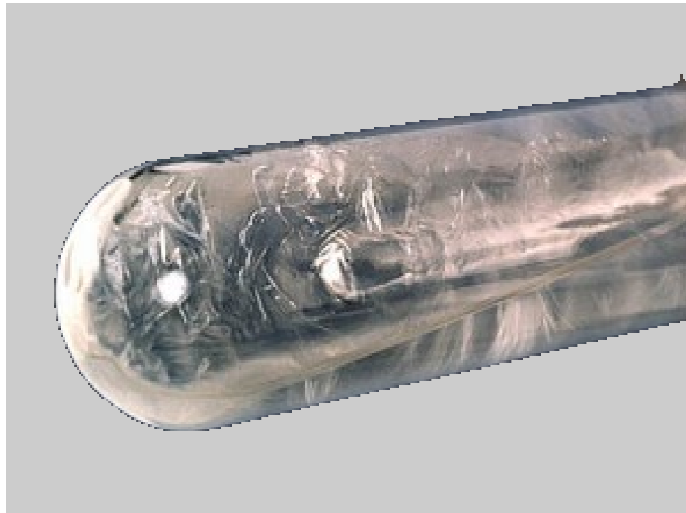
Figure 1 Appareil à point triple de l'eau
