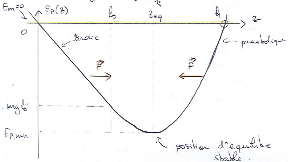
L'intersection de la droite horizontale  $E_m = 0$  et  $E_p(z)$  permet de trouver la hauteur totale de chute  $h$ . (3)
