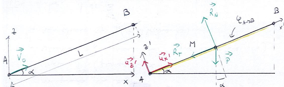
On étudie l'objet assimilé à un pt mat. de mass m dans le ref. du plan incliné supposé galiléen. Le système est soumis à son poids  $\vec{P}$ , à la réaction tangentielle  $\vec{R}_T$ , et à la réaction normale  $\vec{R}_N$  du support.
