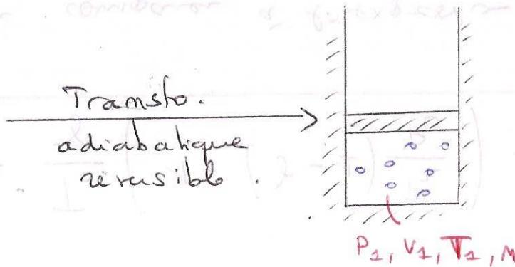
système  $\Sigma = \{\text{air + piston}\}$ .
