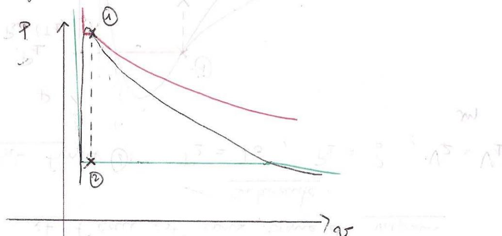
3) Soit  $Q$  le transfert thermique reçu par le système au cours de la transfo. La transfo est isochore donc d'après le 1<sup>er</sup> principe :
