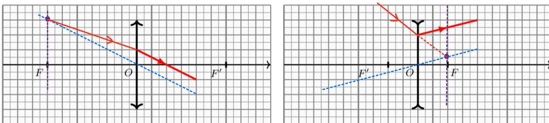
4) Construire l'image  $\vec{A'B'}$  de l'objet  $\vec{AB}$ . Le point  $A$  est confondu avec le foyer principal objet  $F$  de la lentille. Préciser la nature (réelle ou virtuelle) de l'image, si elle est retournée ou droite, et sa taille. Cette construction correspond à la **méthode de l'autocollimation** que vous verrez dans le TP 2 et utiliserez dans les TP 3 & 4! ☺
