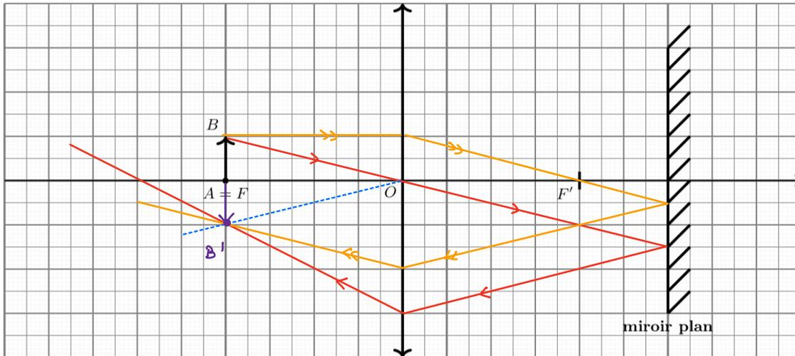
L'image  $\vec{A'B'}$  est réelle : on peut la recueillir sur un écran ( $\vec{A'B'}$  est après la surface de sortie du système optique ; attention, le sens des rayons lumineux a changé après réflexion sur le miroir). Elle est renversée et de même taille que l'objet  $\vec{AB}$ .
