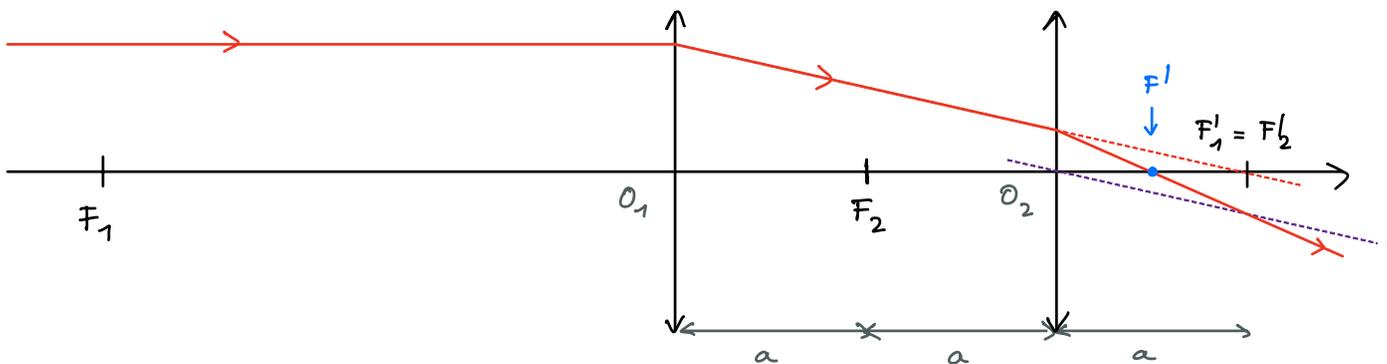
En pratique, un seul rayon suffit. L'intersection du rayon émergent avec l'axe optique est le point  $F'$ . En effet un rayon confondu avec l'axe optique n'est pas dévié.
