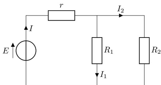
⌚ Déterminer les intensités  $I$ ,  $I_1$  et  $I_2$  des courants et les tensions aux bornes des 3 résistances en fonction de  $E$ ,  $r$ ,  $R_1$  et  $R_2$ .
