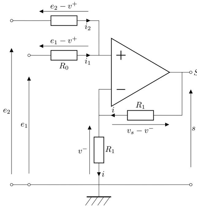
**Ex. 5 Source idéale de courant commandée en tension** ⚡
