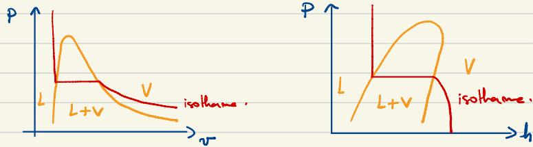
Sous la courbe de saturation, les isothermes sont horizontales ( $P = P_{\text{sat}}$ )
