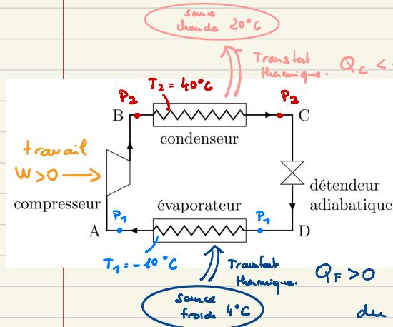
les températures de changement d'état sont choisies pour que le transfert thermique ait lieu dans le bon sens dans l'évaporateur (transfert thermique de la source froide vers le fluide frigorigène) et dans la condenseur (transfert thermique du fluide frigorigène vers la source chaude).
