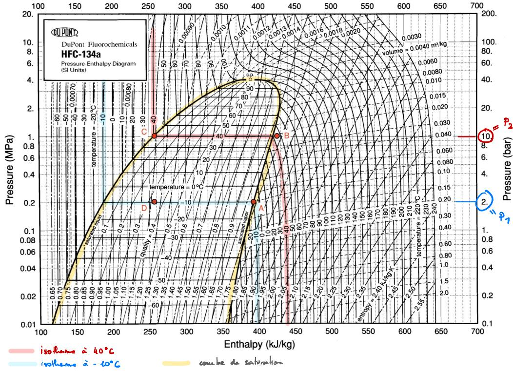
L'allure du diagramme enthalpique ressemble à celle du diagramme de Clapeyron.
